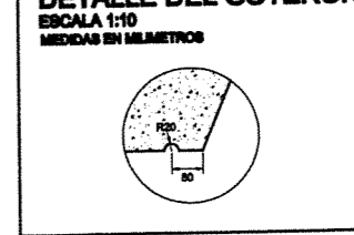
DETALLE DEL GOTERON ESCALA 1:10 MEDIDAS EN MILIMETROS
