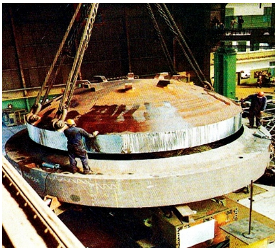
Fabricación en Alemania de la tapa del recipiente de presión del reactor nuclear Atucha II. Ensamble del conjunto domo-bridá para su soldadura. (Fuente: Welding Journal - American Welding Society)
