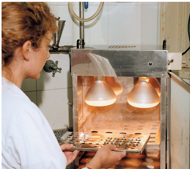
Procesamiento de muestras para la determinación de uranio
