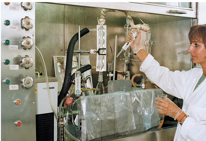
Procesamiento de muestras para la detección de yodo 129
