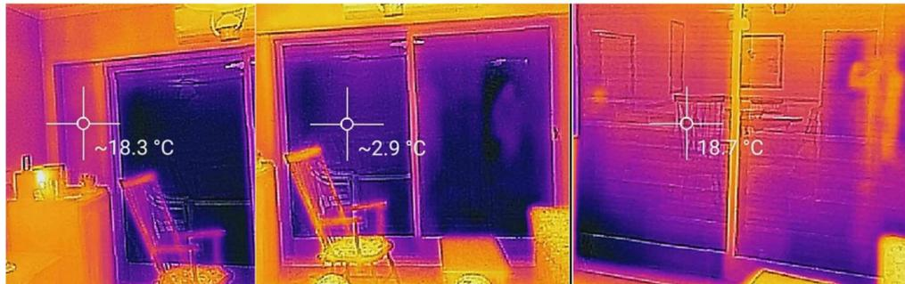
**Figura 29.** Fotos termográficas de una ventana, izquierda medición de la temperatura de la pared (18,3 °C), medio temperatura de la superficie del vidrio (2,9 °C) y derecha temperatura del vidrio una vez que se cierra la persiana de madera (18,7 °C).
