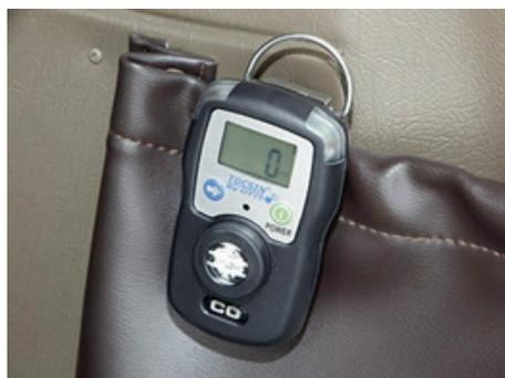
*Detector portátil de CO montado en un bolsillo de la cabina del avión.*
