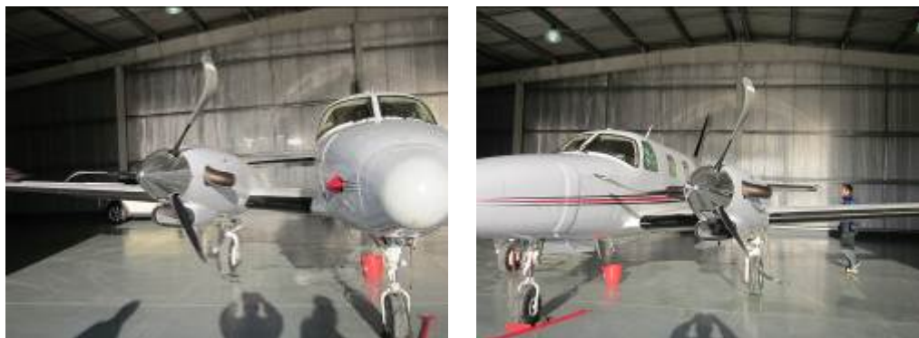
Figura 2. Vista de la aeronave con los daños a las hélices
