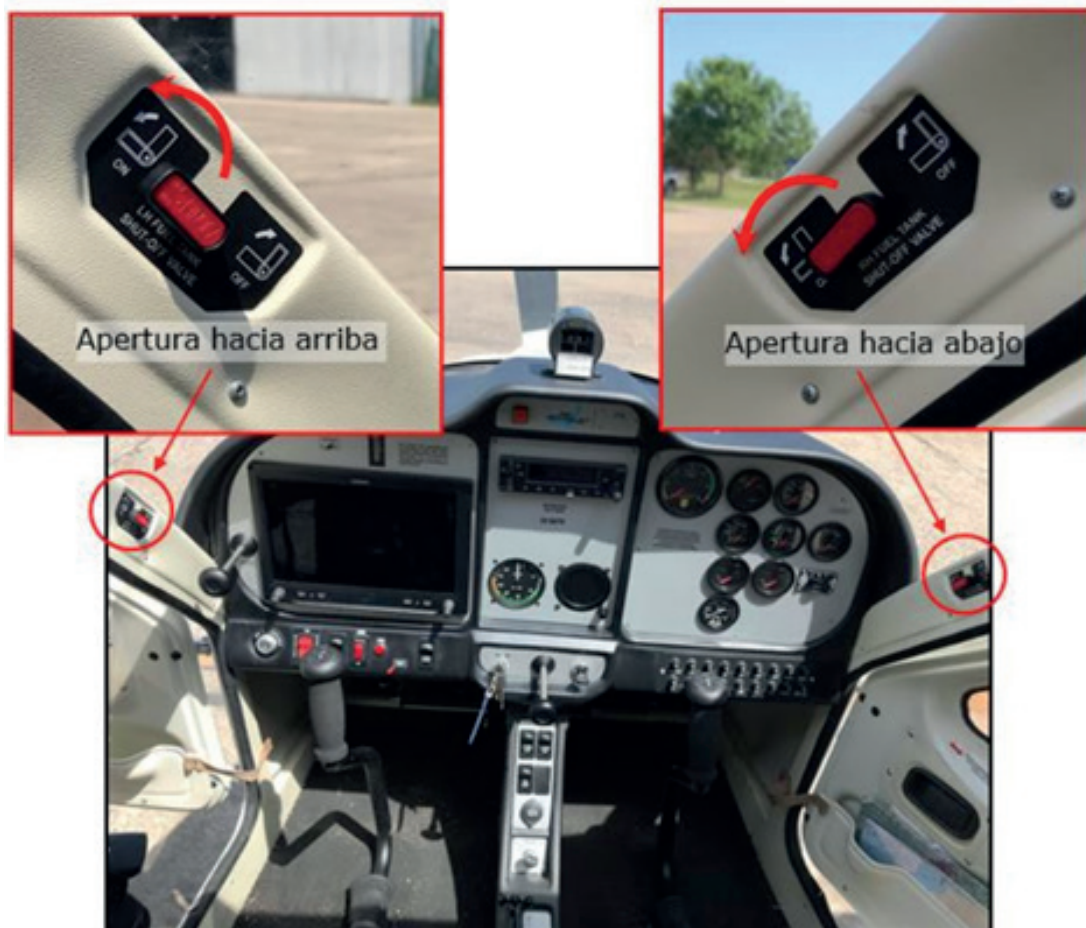
Figura 3: Válvulas selectoras de combustible de una aeronave similar a la accidentada
