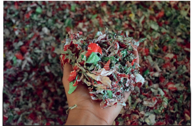
Imagen 1: Plásticos molidos listos para ser procesados
