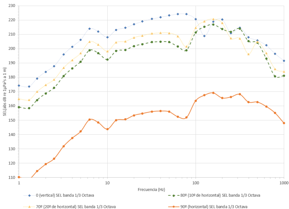
Figura 13. Energía por octava para diferentes ángulos en Azimut 90° (perpendicular al avance).
