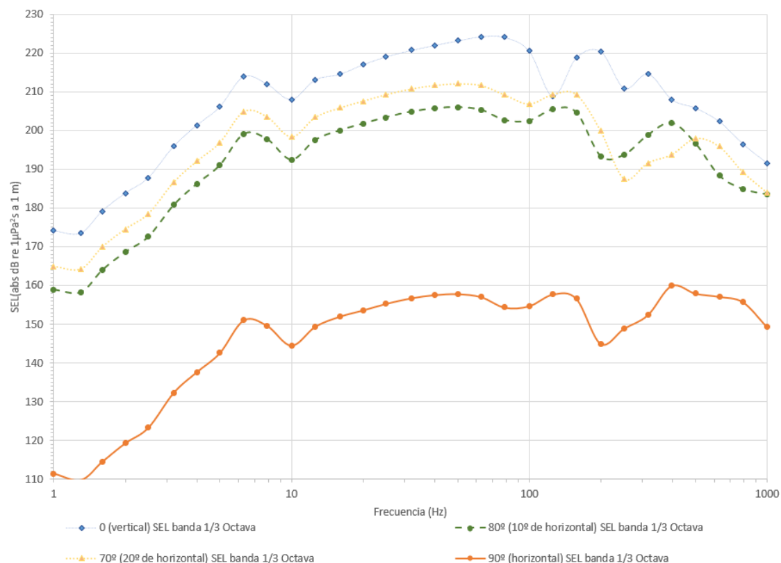
Figura 12. Energía por octava para diferentes ángulos en Azimut 0° (dirección de avance).
