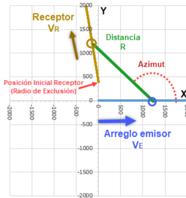
Figura 31. Esquema geométrico utilizado para el cálculo del SELcum.
