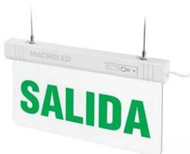
**IL07: Luminaria autónoma LED de emergencia**, tipo Atomlux Modelo 2030 o similar. Tensión y frecuencia de alimentación 220VCA – 50Hz/60Hz. 30 LEDs blancos de alto brillo, batería de litio. Autonomía 3 a 6hs según opción de brillo, tiempo de carga de batería 24hs. Dimensiones aproximadas 67 x 39 x 22cm.. Cantidad: **6 (SEIS) unidades**
