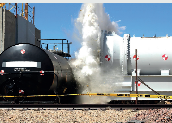
Figura 1. Muro de impacto y ram car especialmente diseñados para diversos escenarios de pruebas de colisión
