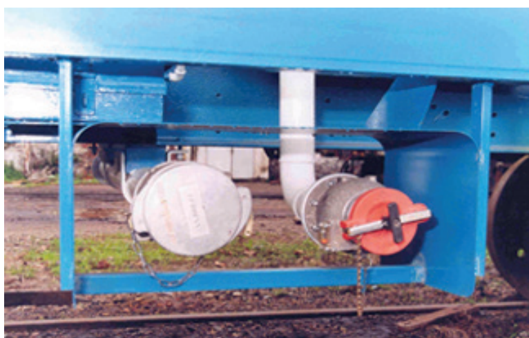
Figura 2. Acople carga y descarga para retorno de gases
