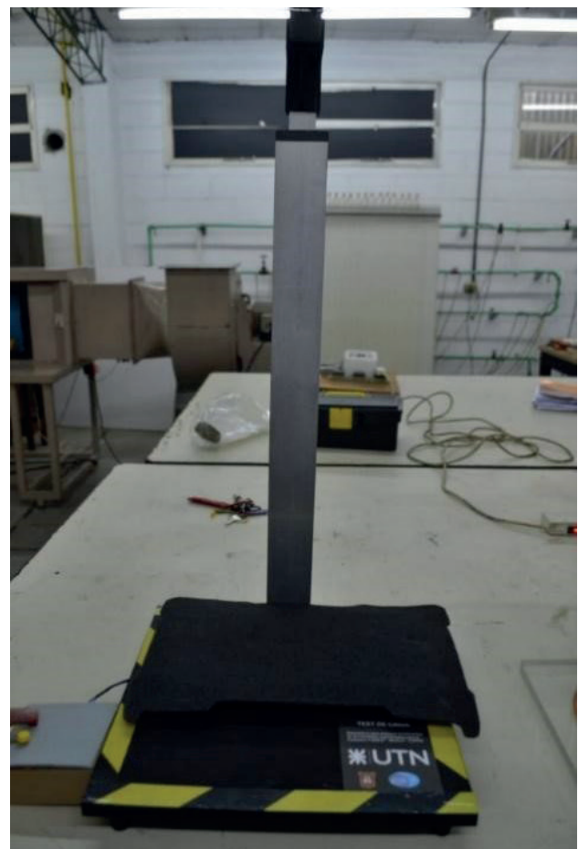
Figura 2. El dispositivo de ensayo de caída en el LAYF de la UTN FRH
