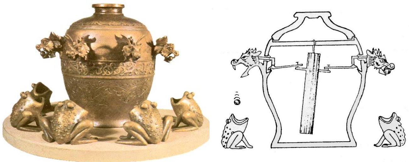
Figura 1: Primer sismógrafo inventado por el científico chino Hang Chen (Año 132 d.C.)
