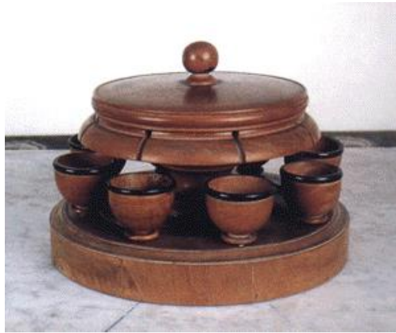
Figura 2: Sismoscopio construido por el abate Jean de Hautefeuille.
