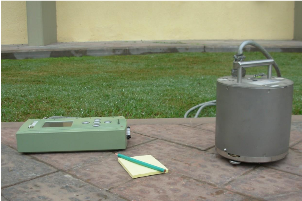
Figura 6: A la derecha, sismómetro de banda ancha (BB) modelo 40-T (Güralp), de tres componentes, con respuesta plana en el rango frecuencial de 33,3mHz (30 seg) a 50 Hz. A la izquierda, sistema digital de adquisición de datos TAURUS (Nanometrics Inc.), de 24 bits.
