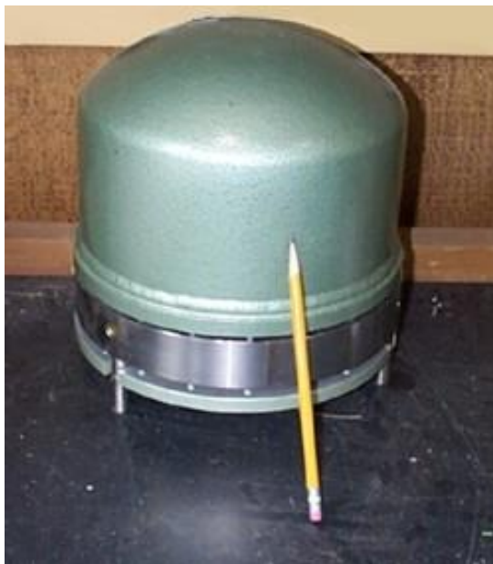
Figura 5: Sismómetro de Banda Ancha (BB) de tres componentes, modelo STS-2 (Streckeisen) de 9 Kg. Respuesta plana en el rango frecuencial de 8,3mHz (120 seg) a 50 Hz.
