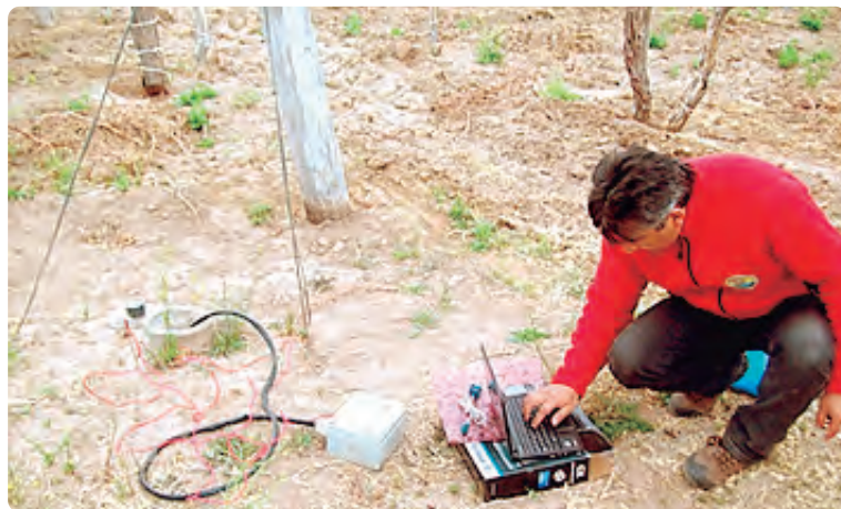
FOTO 09 Determinación de conductividad hidráulica en un freático.
