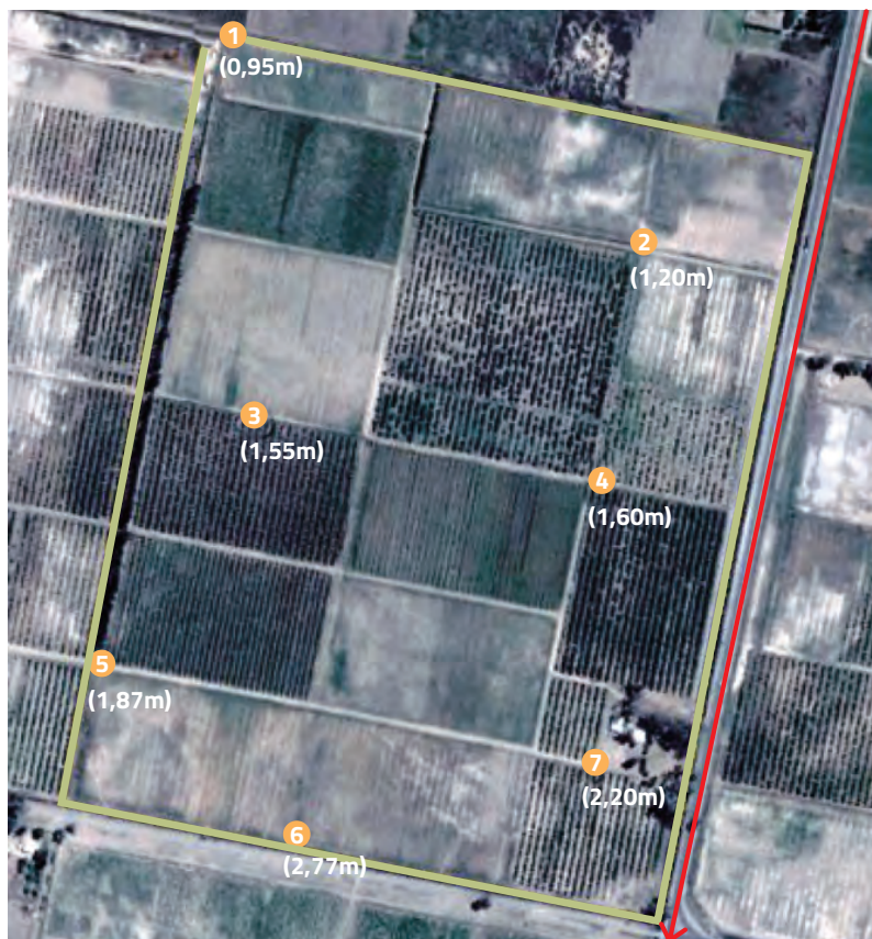
Fig. 07 Lectura en una red de frentómetros instalados en una propiedad.
