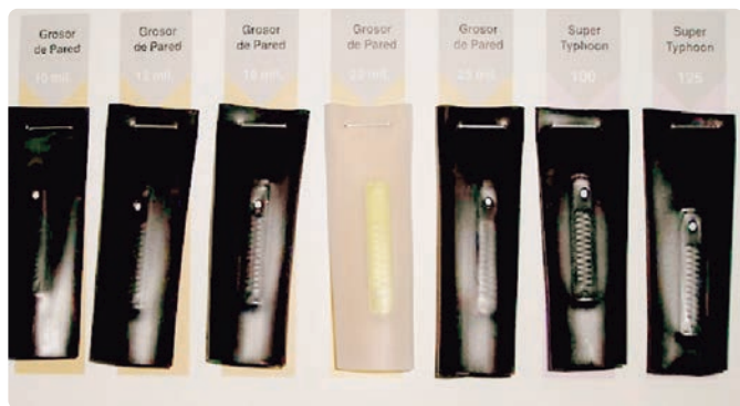
FOTO 16 Cintas de goteo.
