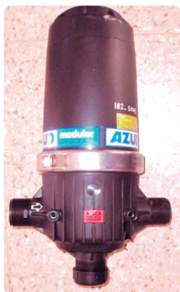
FOTO 08 Filtro de anillas de 2" armado.
