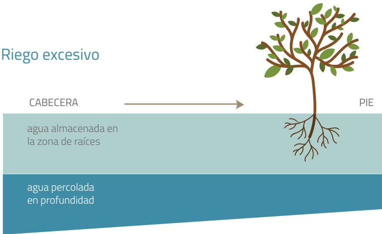
Fig. 2 Esquema de agua almacenada y percolada después de un riego excesivo.
