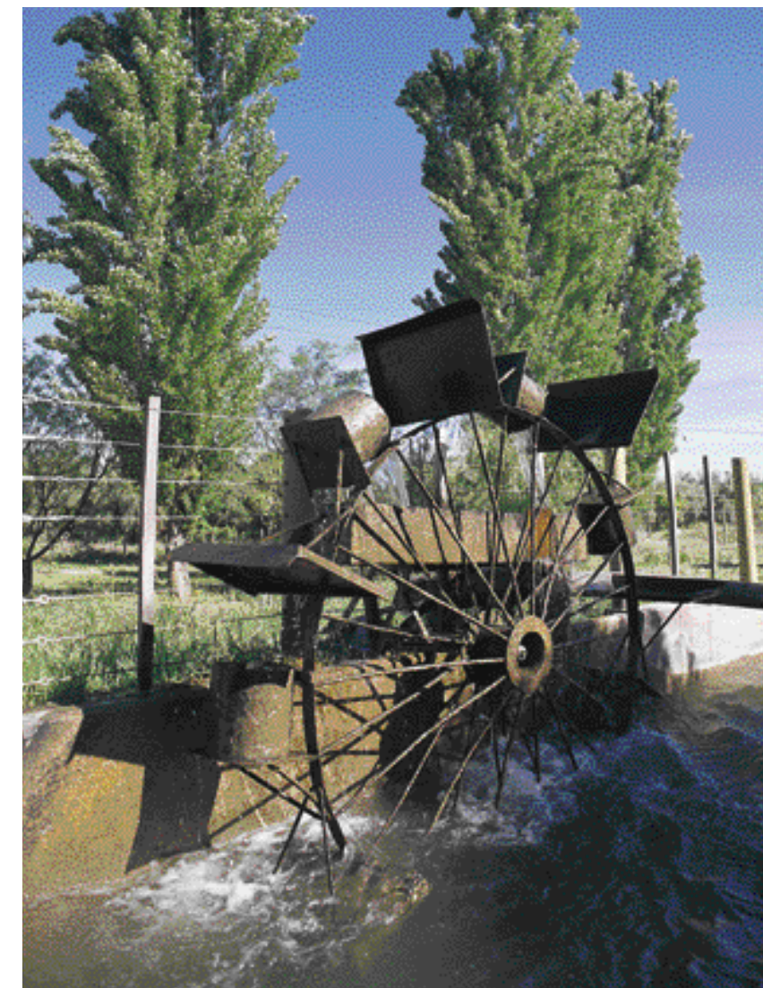
▲ Antigua rueda hidráulica para elevar agua. Mendoza.
