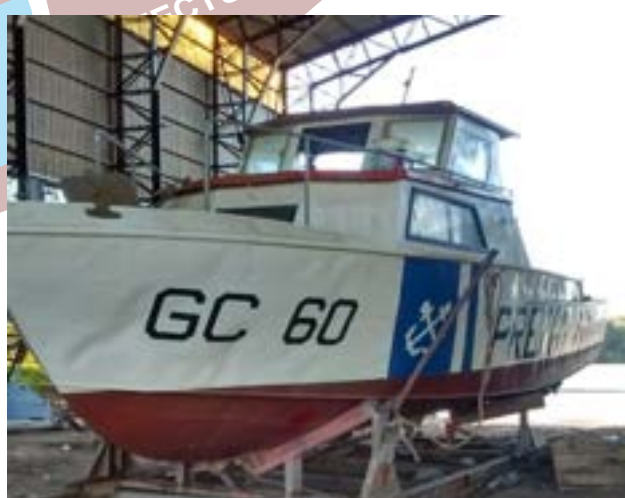
Fotografía correspondiente a la puesta a seco de embarcaciones para trabajos de carenado.
