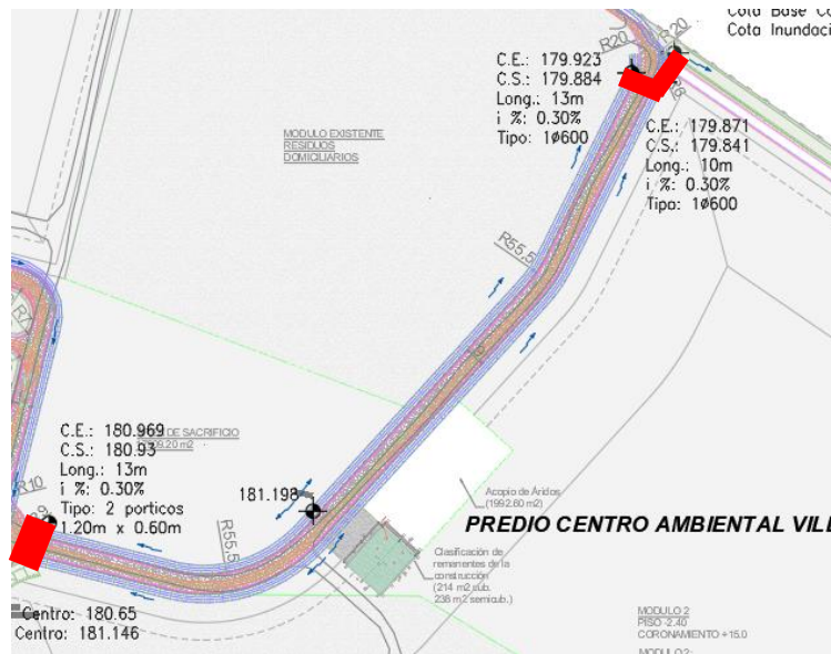
Figura 15: Alcantarillas en Vialidad Interna
