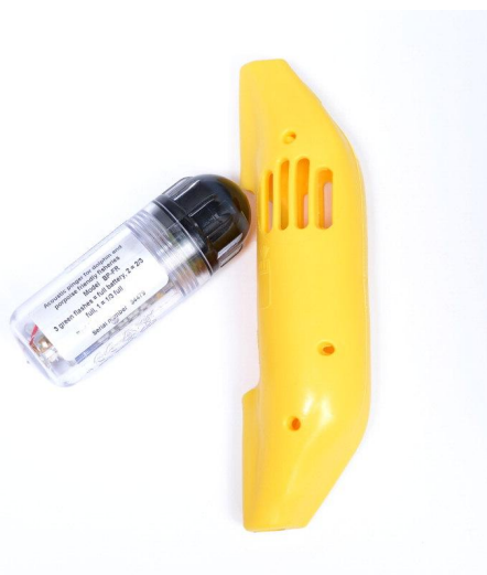
Fig 1. Fotografía de dispositivo acústico ( Banana pinger ) a utilizar como posible medida de mitigación para disminuir las interacciones entre mamíferos marinos y la pesquería de anchoíta bonaerense.
