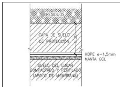
Detalle de impermeabilización de fondo de celda para el caso de manta GCL
