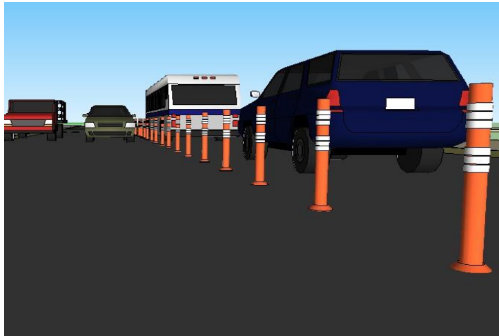
Imagen N° 35. Delineadores (Guía práctica de diseño Moderación del Tránsito – Observatorio ANSV).
