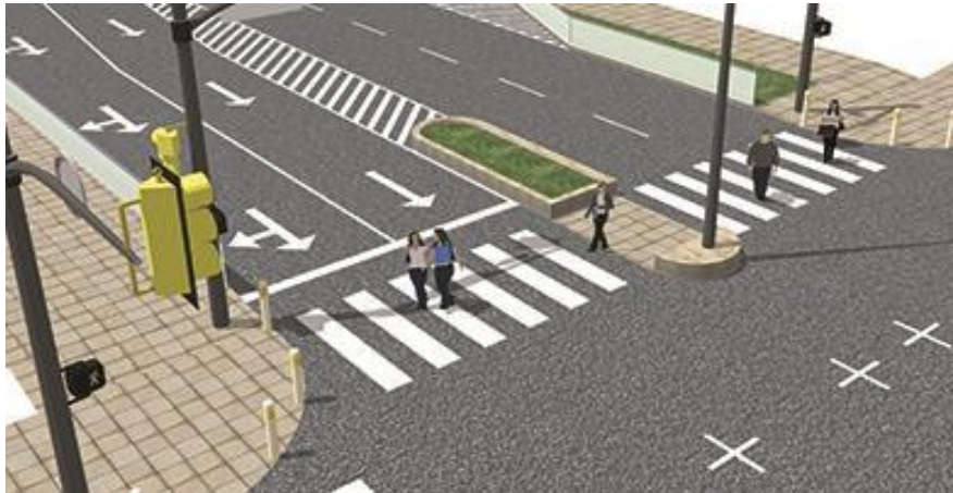
Imagen N° 29. Ejemplo refugio peatonal en intersección (Ciudades más seguras mediante el diseño, Instituto de Recursos Mundiales (WRI), 2016).
