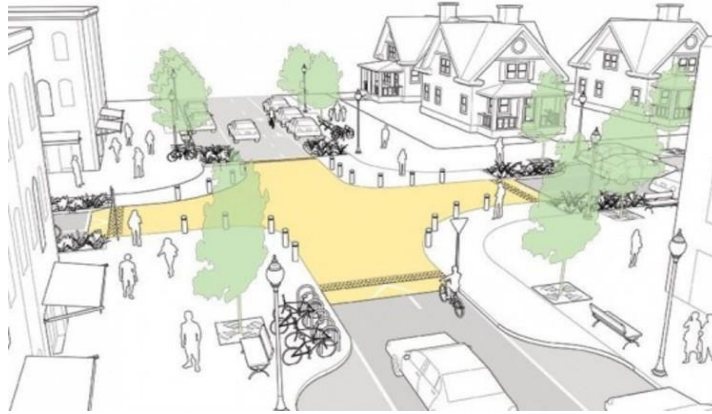
Imagen N° 25. Ejemplo intersección elevada (Plataforma Urbana, 2015).
