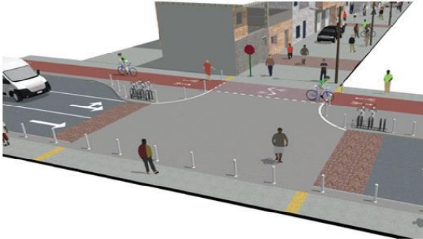
Imagen Nº 26. Vista en plata de cruce peatonal elevado (Ciudades más seguras mediante el diseño, Instituto de Recursos Mundiales (WRI), 2016).
