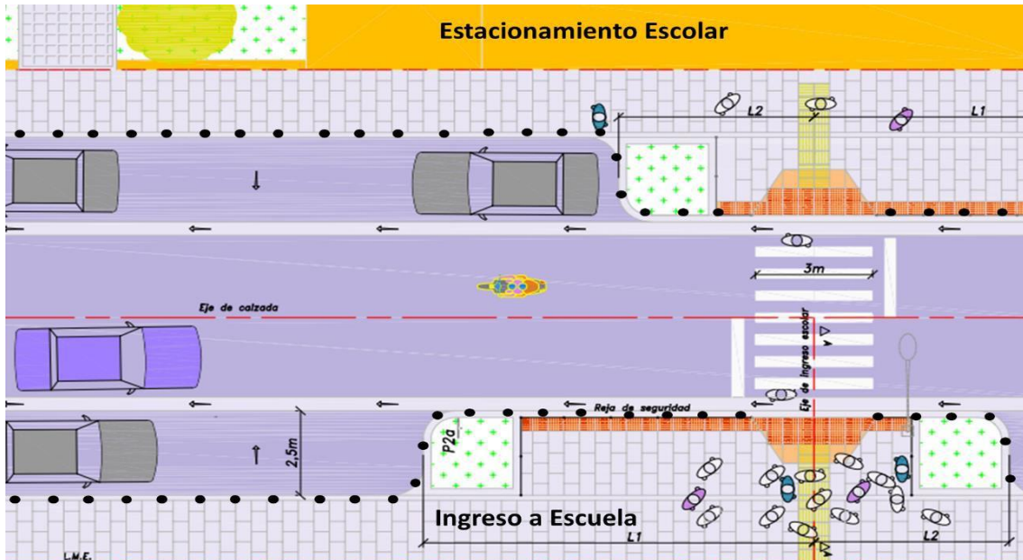
Imagen Nº 54. Cruce peatonal en escuela (Guía práctica de diseño Moderación del Tránsito – Observatorio ANSV).
