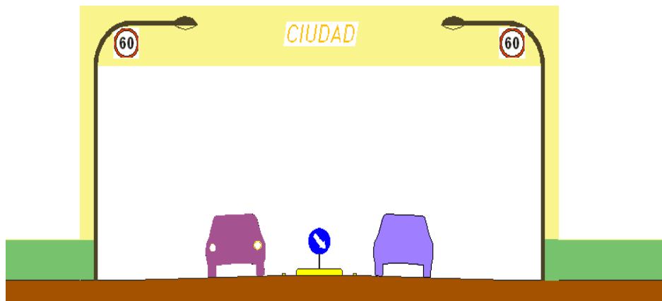
Imagen N° 43. Vista de frente de una puerta de entrada (Guía práctica de diseño Moderación del Tránsito – Observatorio ANSV).
