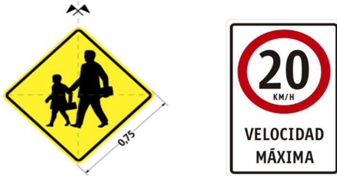
Imagen N° 52. Cartelería básica necesaria para zonas escolares (Manual de Señalamiento Vertical de la DNV).
