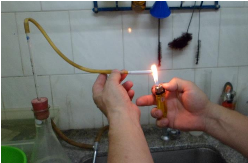
Fig.3.15.- Combustión de cigarrillo de tabaco; succión realizada mediante bomba de vacío (izq).
