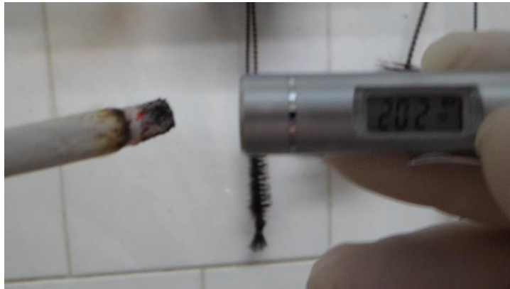
Fig. 3.17.- Medición de temperatura de combustión de cigarrillo de tabaco, el lector marca 202 °C.
