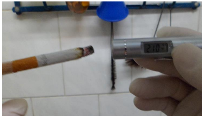
Fig. 3.18.- Medición de temperatura de combustión de cigarrillo de tabaco, el lector marca 210 °C.
