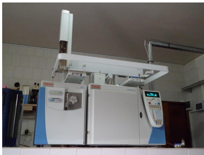
Fig. 3.8.- Cromatógrafo de Gases utilizado en el análisis de la muestras.
