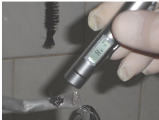
Fig. 3.26.- Ensayo de combustión sólo con viruta metálica. Temperatura sobrepasa el límite de detección.
