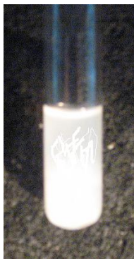
Fig. 3.10.- Reacción positiva para la presencia de iones cloruros; notar la formación de flóculos de color blanco.
