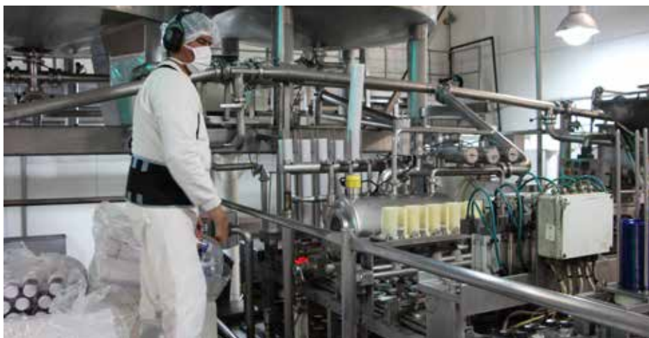
Máquina envasadora de dulce de leche. Fuente: SRT (2016)
