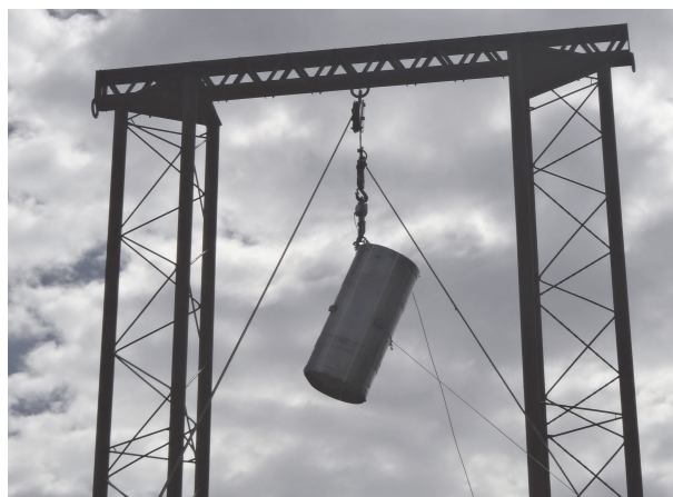
Ensayo durante licenciamiento de diseño de bulto de transporte
