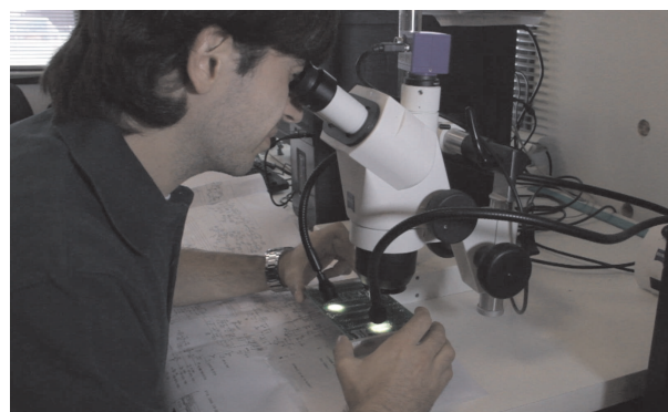
Verificación de circuitos electrónicos del sistema de protección del reactor en la Central Nuclear Atucha II
