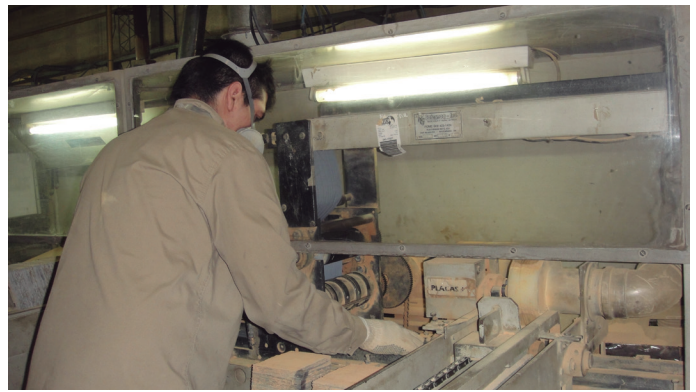
Proceso de estacionamiento de placas de plomo.
