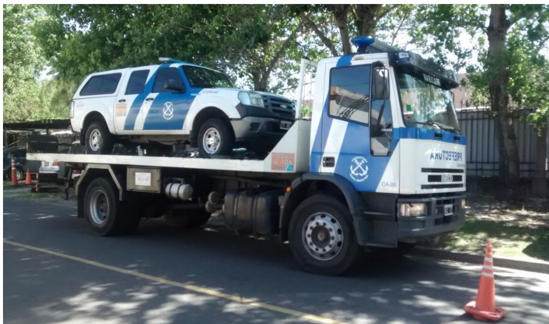
FIG 3: CAMIÓN DE AUXILIO (SIGLA CA-08 - GRÚA EUROCARGO170 E22) – SERVICIO DE AUXILIO MECÁNICO
