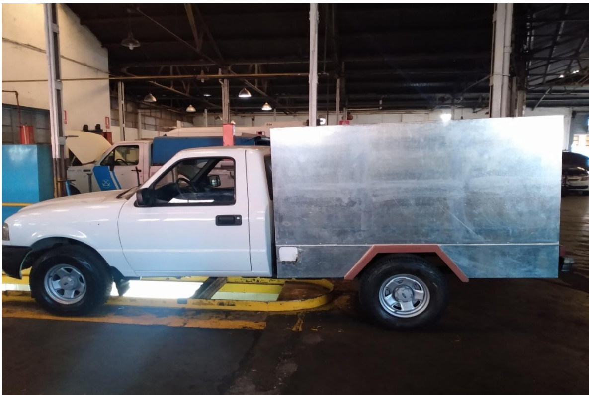
FIG11: FF-06 - MONTAGE ESTRUCTURA CARROCERIA NUEVA- SECCION CHAPA - TA.GE.RE.AU
