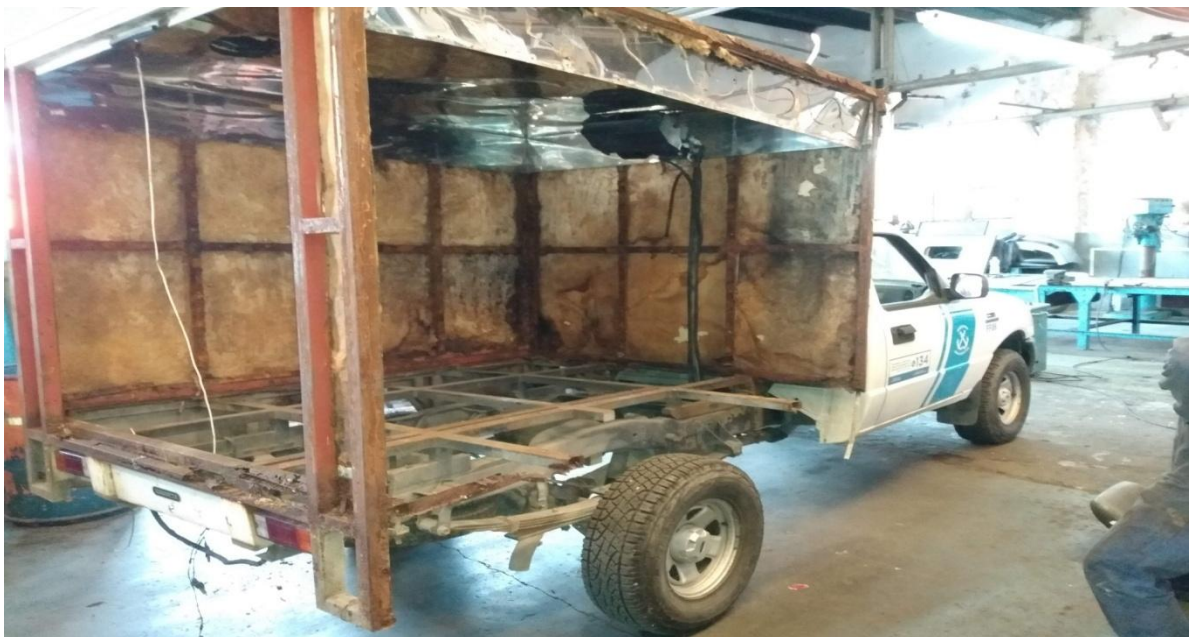
FIG9: FF-06 – TRABAJOS DE DESMONTAJE ESTRUCTURA ANTIGUA - SECCION CHAPA – TA.GE.RE.AU
