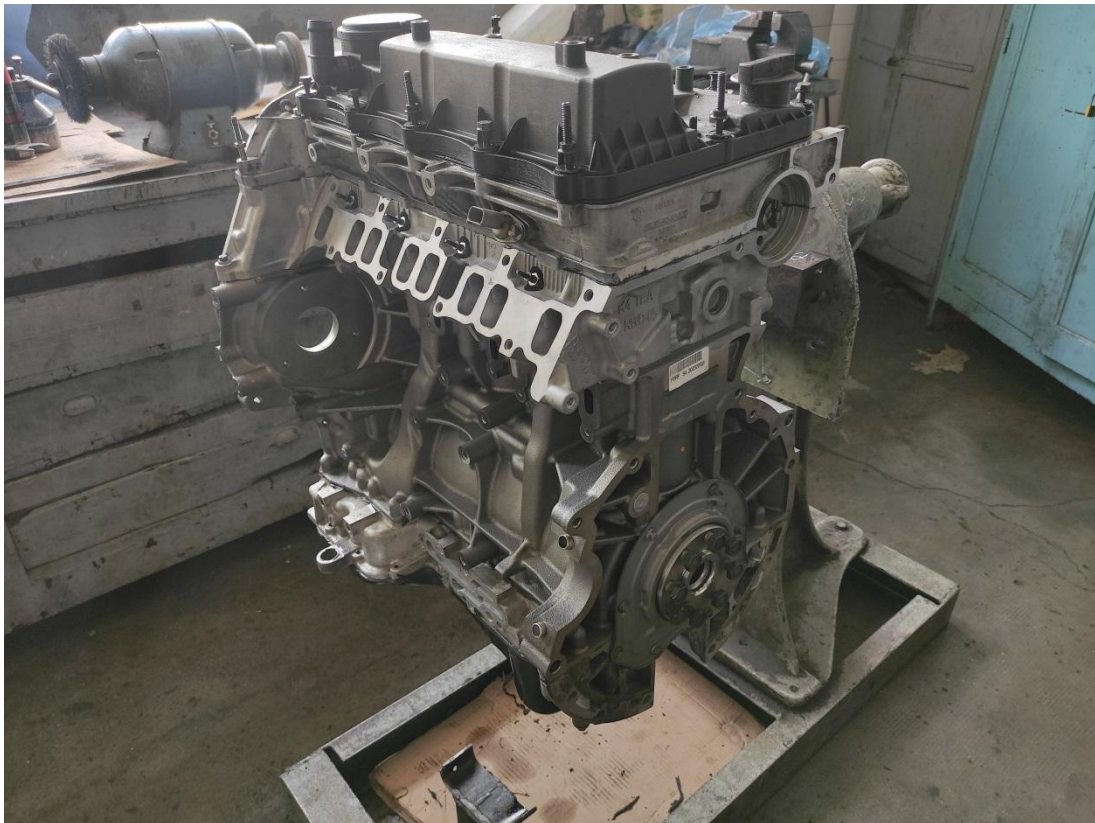
FIG 4: PLANTA MOTRIZ FORD RANGER 2.2 – REPARACIÓN Y POSTERIOR MONTAJE EN VEHÍCULO – SECCIÓN AJUSTE TA.GE.RE.AU.
