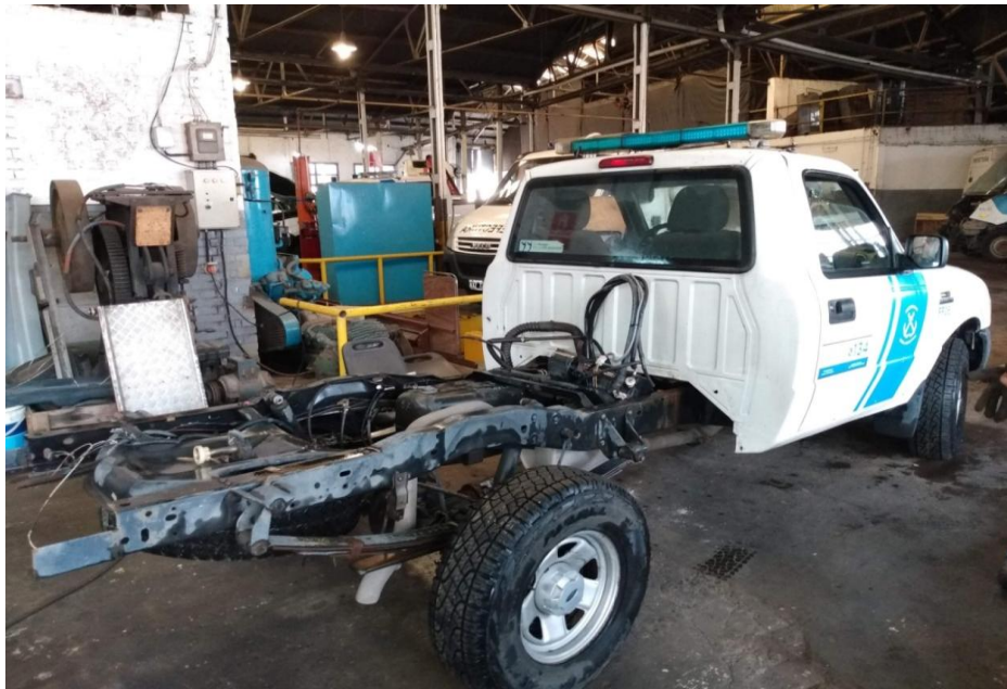
FIG10: FF-06 - DESARME DE CAJA CARROCERIA PARA REACONDICIONAMIENTO DE LA BASE- SECCION CHAPA - TA.GE.RE.AU
